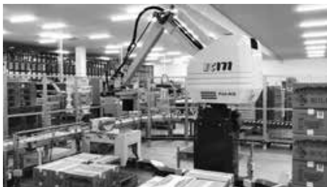
写真5 GPセンター内に導入された段積みロボット 資料：筆者撮影
